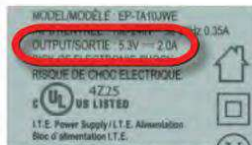
चित्र 11.29M मोबाइल चार्जरमा उल्लेख गरिएको भोल्टेज रेटिङ
